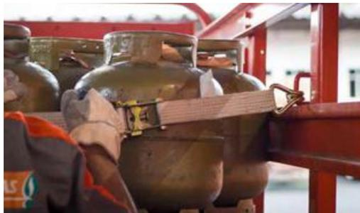
6.15.12 Para as cargas que não ocuparem toda a carroceria no sentido longitudinal, restando espaços vazios nos painéis traseiros e frontal, devem ser previstos pelo transportador, além dos dispositivos de amarração, outros dispositivos diagonais que impeçam os movimentos para frente e para trás da carga.
